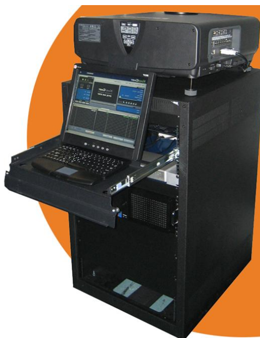
Foto ilustrativa de um equipamento para salas digitais: em cima está o projetor, embaixo o servidor e um notebook mostrando a interface do software de gerenciamento de arquivos – Kinocast.
